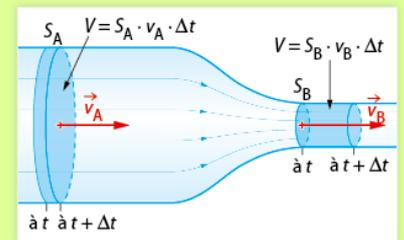
**Remarque :** Si  $S_A > S_B$  alors  $v_B > v_A \Rightarrow$  La vitesse du fluide augmente lorsque la section du conduit rétrécit.
