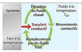
Représentation du transfert conducto-convectif : si  $T_{\rm ext} < T$  le fluide s'échauffe au contact de la face, sa masse volumique diminue , il s'élève puis il est remplacé par du fluide frais.
