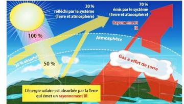
En divisant l'équation précédente par  $\Delta t$ , on obtient un bilan de flux (puissances thermiques) :  $\mathcal{G}_T + \mathcal{G}_R + \mathcal{G}_E = 0$ En divisant ce bilan par la surface S du système, on obtient un bilan de puissances surfaciques :  $p_T + p_R + p_E = 0$
