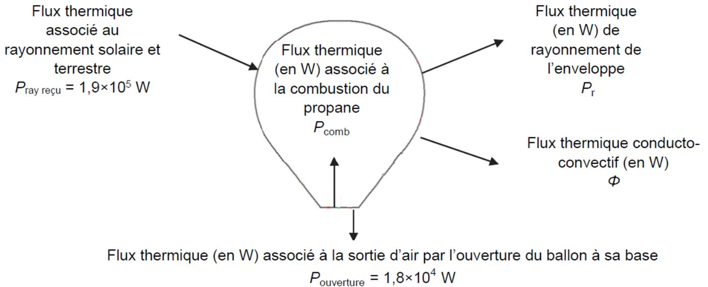
Figure 3. Bilan de puissance du système
