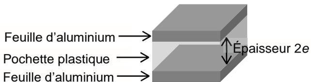
Figure 4. Coupe du condensateur réalisé (sans souci d'échelle)
