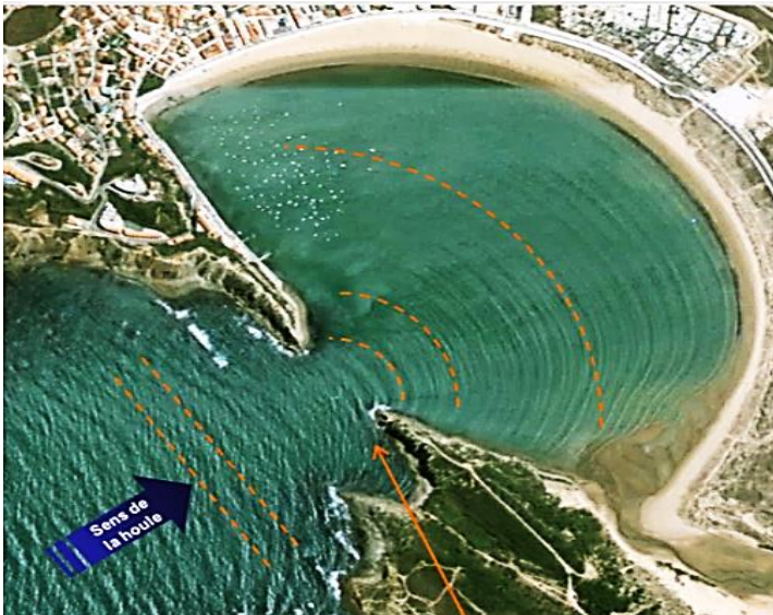
La houle linéaire qui arrive du large est diffractée au passage de l'ouverture de la baie et change de direction.
